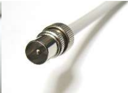
④ PAL 型コネクタ (オス) の加工例
