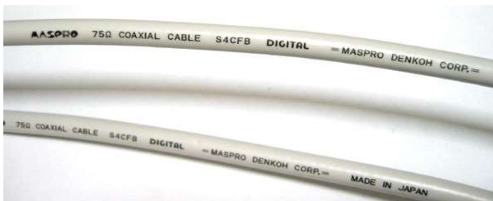
写真 2-1 衛星放送に対応したアンテナケーブルの例
