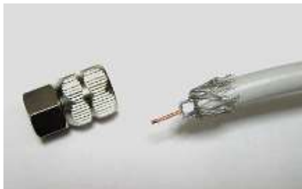
⑤内部絶縁を剥く
