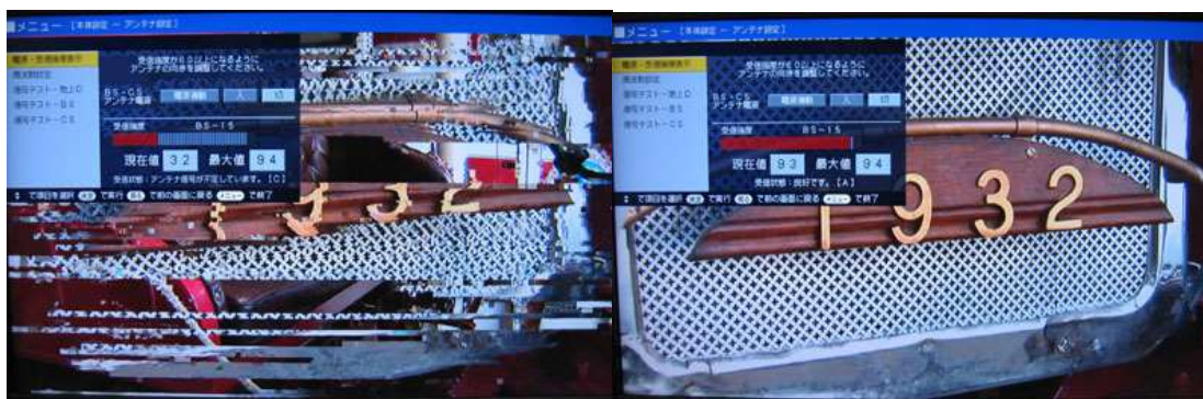
①アンテナ方向の微調整前の TV 画面の例
