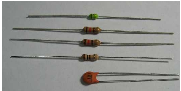
アッテネーター(10dB)製作用の部品 (上から、インダクター、抵抗器3本、コンデンサー)
