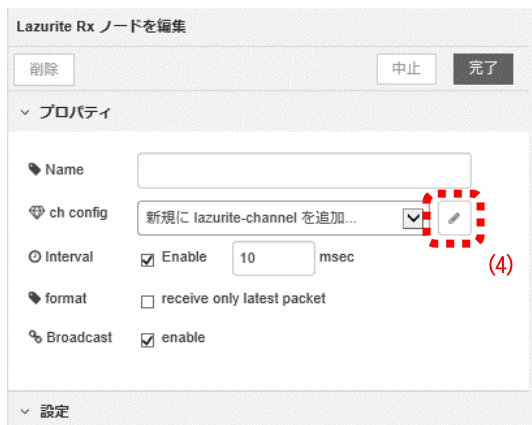
図 14-2 Lazurite Rx ノードのプロパティ画面で鉛筆アイコンをクリックする
