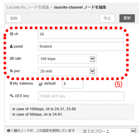
図 14-3 ch に「36」を、panid に「0xabcd」を、rate に「100kbps」を、Tx pwr に「20 mW」を入力し、[更新] ボタンをクリックする。
