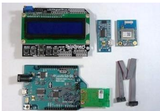
写真 4-1 Lazurite を使った Sub-GHz 実験に必要な機器 Sub-GHz 無線の送信機には、Lazurite mini シリーズの 920J (右上) を、受信機には Arduino 用 LCD Keypad シールド (左上) を接続した Lazurite Sub-GHz (左下) を用いた。ファームウェアを Lazurite mini シリーズへ書き込むには、Lazurite mini writer Type B (右上) が必要。
