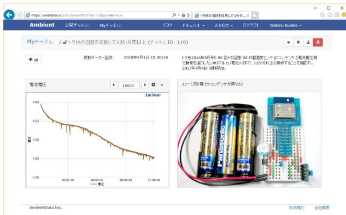
図 17-1 IoT 用クラウドサービス Ambient で Wi-Fi モジュール ESP-WROOM-02 を 1 年間動作させたときの様子
