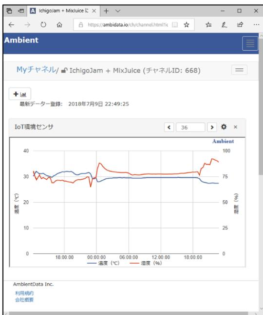
図 2-6 Wi-Fi 対応 IoT 温湿度センサから Ambient へ 温度+湿度データを送信したときの様子
