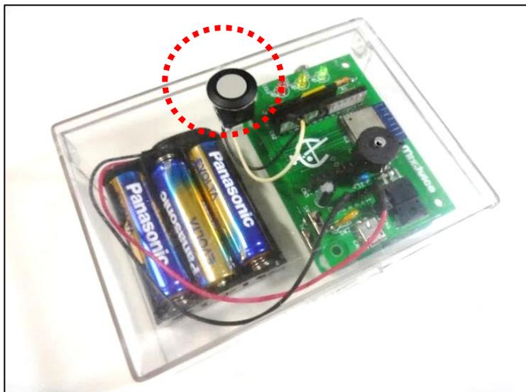
写真 2-4 ボタン SW2 と並列にプッシュ・スイッチを取り付けたときの様子
