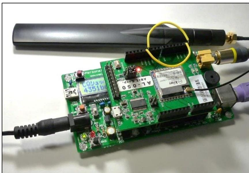
写真 3-10 LoRaWAN 開発シールドを Arduino シールド対応 IchigoJam 用マイコン・ボードに接続した
