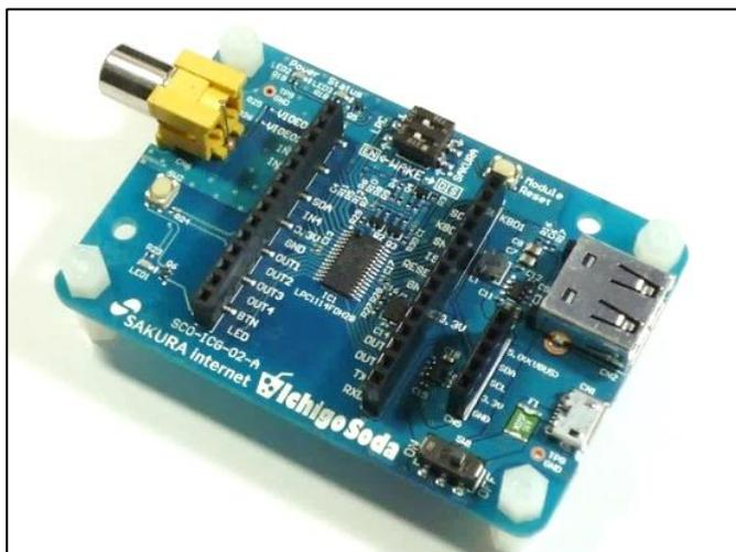
写真 0-4 sakura.io モジュールを搭載可能なマイコン・ボード IchigoSoda
