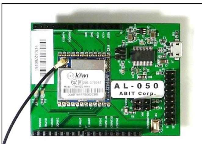
写真 0-6 LoRaWAN 開発ボード AL-050
