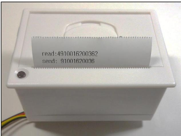
写真 3-8 バーコード・リーダーで読み取ったコードを、レシート・プリンタ QR204 で印刷した 13 桁の JAN コードを読み取り、前後 1 桁を除いた 11 桁のコードを LoRaWAN 送信したときの印字例
