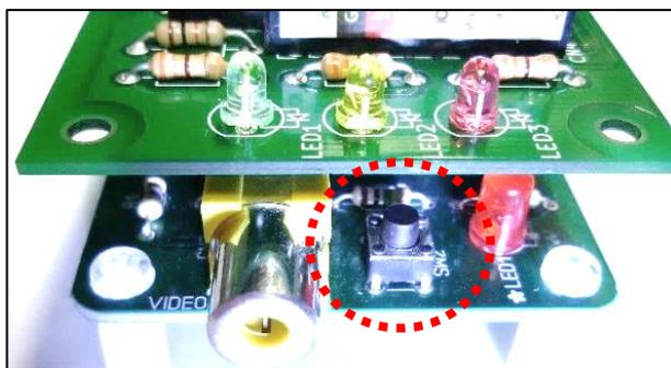
写真 2-3 MixJuice 基板と接続すると IchigoJam のボタン SW2 が押しにくくなる
