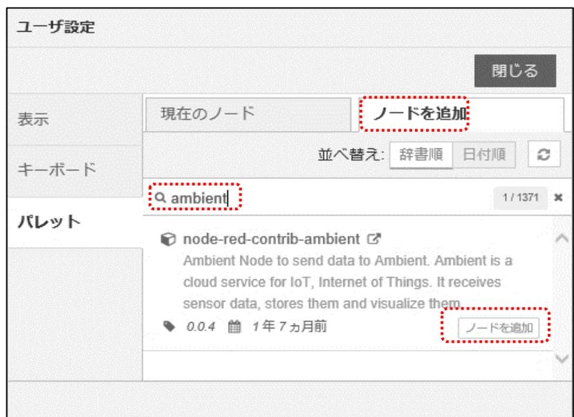
図 1-22 [パレットの管理]メニューでタブ[ノードを追加]を選択し、検索窓に「ambient」を入力すると node-red-contrib-ambient が見つかるので、[ノードを追加]ボタンをクリックする
