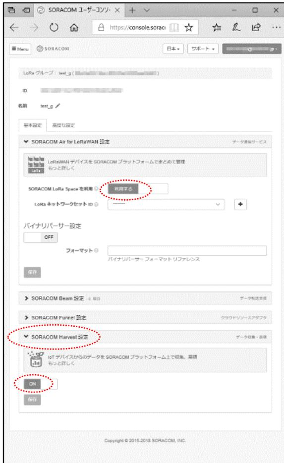
図 3-2 SORACOM ユーザ・コンソールで LoRa グループの設定を行う
