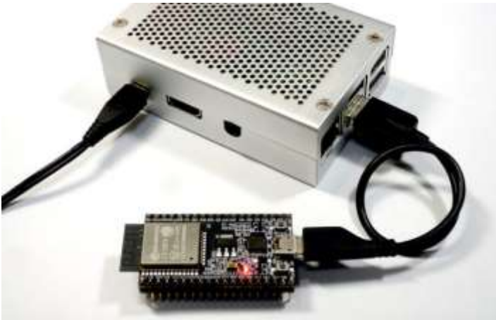
写真1 Raspberry Pi と ESP マイコン開発ボードの接続例
