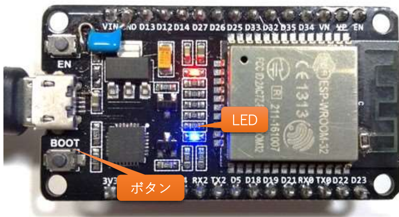
写真 2 ESP32 マイコン用 MicroPython で L チカ LED を点滅させる L チカのサンプル・プログラム test_led_btn.py を DOIT 製 ESP32 開発ボード Dev Kit V1 上で実行したときの様子
